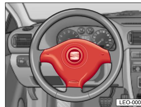
Вместе с ремнями безопасности, система подушек безопасности предоставляет дополнительную защиту для головы и грудной клетки водителя и пассажира при серьёзных лобовых столкновениях.
